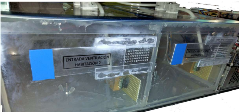
Detalle de las entradas de ventilación (simulación de puertas y ventanas)
