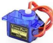
Aspecto do servomotor empregado para o control da reixa
