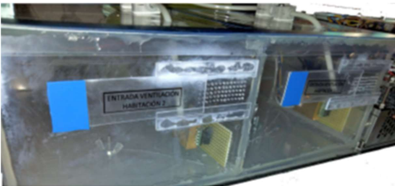
Detalle das entradas de ventilación (simulación de portas e ventás)
